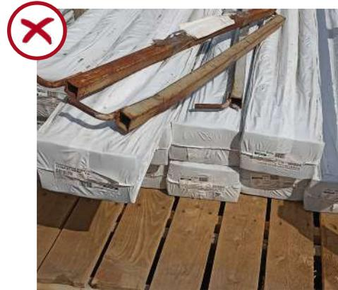
**1.5** Продукция не хранится на бетонном, асфальтированном основании:
